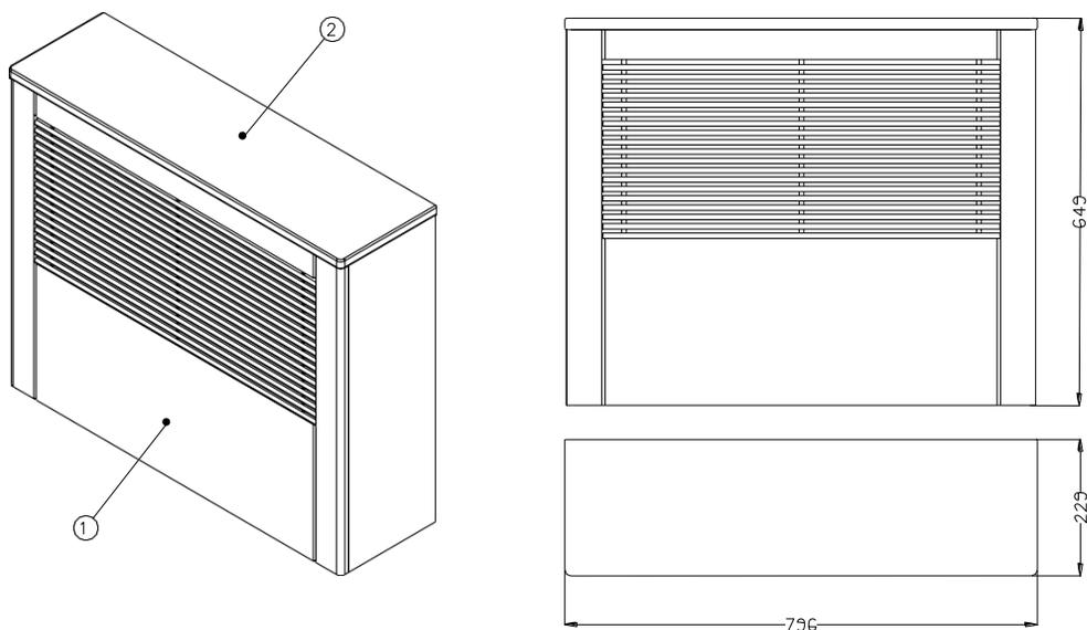
Il mobiletto va fissato alla parete, ad una altezza consigliata di 15-20 cm dal pavimento. Per il fissaggio vanno utilizzati i fori  $\varnothing=5\text{mm}$  presenti sulle quattro squadrette metalliche all'interno della cornice.
